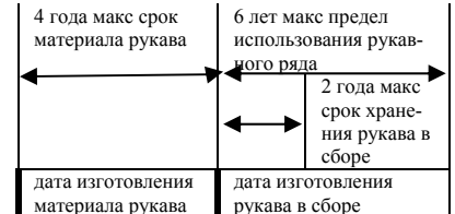
fig.1 Ограничения хранения и использования рукава согласно DIN 20066, часть 5
